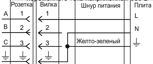
Схема подключения плиты к трехфазной электрической сети переменного тока напряжением 380 В
